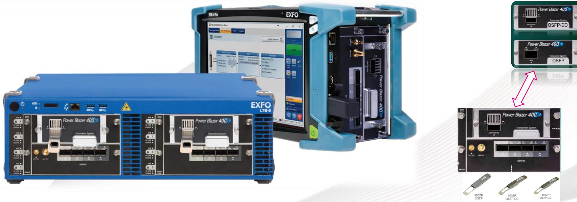
Die Lösung von EXFO unterstützt beide kohärenten Typen QSFP-DD und OSFP
